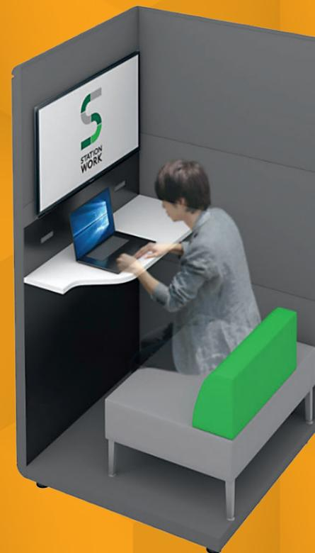
แคปซูลออฟฟิศขนาดเล็กคล้ายตู้โทรศัพท์ขนาดพอดีตัวสำหรับ 1 คน เป็นบริการพื้นที่ทำงานซึ่งอยู่ในชั้นทดลองของสถานีรถไฟญี่ปุ่น โดยภายในแคปซูลออฟฟิศชื่อ สเตชันบูธ (Station Booth) นี้ มีสิ่งอำนวยความสะดวกในการทำงานอยู่ ประกอบด้วยจอทีวีสายต่อ USB และ HDMI เต้าเสียบปลั๊กไฟ และมีบริการไวไฟ เพียงนำโน้ตบุ๊กมาก็สามารถทำงานขณะรอรถไฟได้โดยไม่ตกเป็นเป้าสายตาคอน ดอบใจത്യความเป็นส่วนตัวด้วยผนังเก็บเสียงช่วยสร้างสภาพแวดล้อมที่เงียบสงบเหมาะแก่การทำงานและสนทนาทางโทรศัพท์ โดยเฉพาะงานสำคัญของบริษัทที่ต้องเก็บเป็นความลับ
